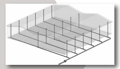
Nestes sistemas os Ralos são conectados a condutores verticais e depois a condutores horizontais que precisam de certa declividade. Quando os trechos horizontais são muito longos e não é possível proporcionar a inclinação mínima necessária devido ao espaço limitado disponível, a única solução é aumentar o tamanho das tubulações com o conseguinte aumento nos custos de instalação.
