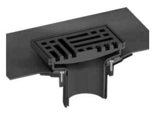
I. Finalmente, desliza-se o Sobre Ralo dentro do Corpo. A longitude do Sobre Ralo permite uma ampla regulagem da altura final da grelha, dependendo da espessura da camada de contrapiso e do revestimento. No caso do ralo horizontal, uma vez determinada a altura final do piso acabado, deve-se cortar o comprimento do sobre ralo excedente para evitar que o mesmo obstrua o trecho horizontal.
