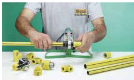
2. Aquecimento do tubo e da conexão a 260 °C
