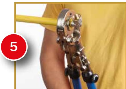
**Nota:** Depois de finalizado o processo de união, a conexão ficará impossibilitada de realizar qualquer tipo de movimento de torção no tubo multicamada.
