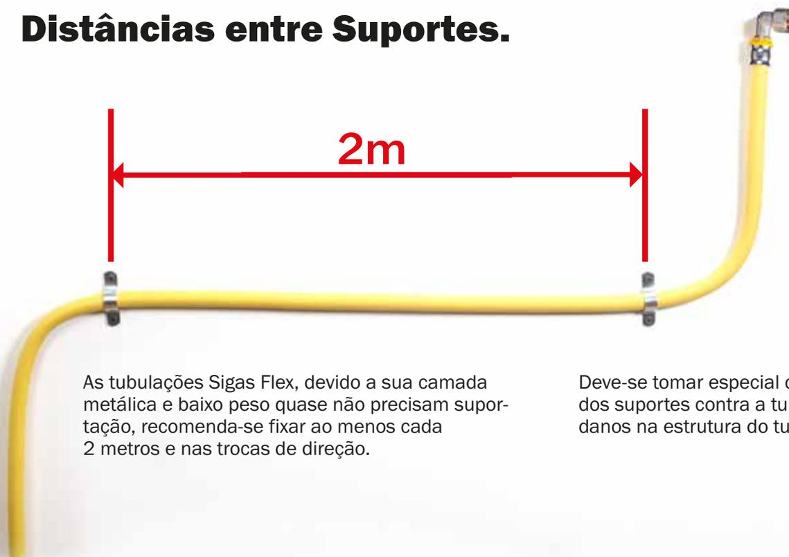
As tubulações Sigas Flex, devido a sua camada metálica e baixo peso quase não precisam suporta-ção, recomenda-se fixar ao menos cada 2 metros e nas trocas de direção.
